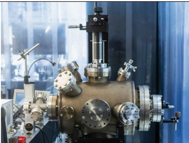
A Wigner FK RMI lézertudományi laboratóriumában használt vákuumkamra azért kell, mert a nagy teljesítményű fókuszált lézertér egy levegőben túlságosan szóródna, energiát veszítene.
